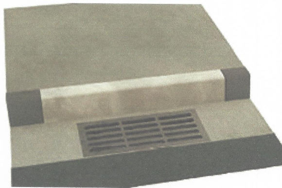
Figura 9 - Boca de Lobo Tipo Grelha
